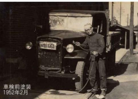
仕上げは塗装。 この時の車検では荷台の床板に僅かな穴（葉書よりも小さかったと記憶しています）があり不合格となりました。 車検は全く機器類を使わず、検査員が運転し、燈火、警音器、アポロ（方向指示器：現在のようなウインカーはなく、腕木式）ブレーキの作動をチェックするのみでした。
