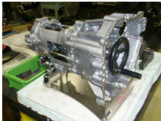
普段は、工場(ものづくり支援センター、実習工場A棟)に居ります。写真は、学生向けの教材変速装置のカットモデルです。
